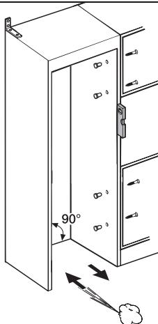
Перед встраиванием прибора следует выполнить тщательное выравнивание мебельного шкафа с помощью ватерпаса. Все углы шкафа должны составлять 90°, так как иначе дверца не будет прилегать со всех 4 углов.
